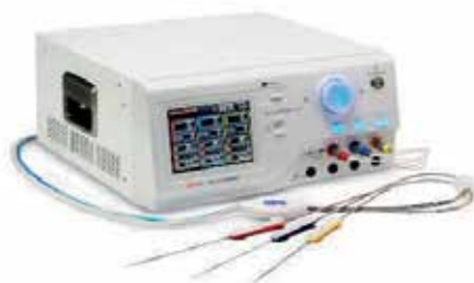
RF GENERATOR VIVA VMRFs ZA PERKUTANU RF ABLACIJU TUMORA POMOĆU ULTRAZVUČNOG NAVODJENJA
